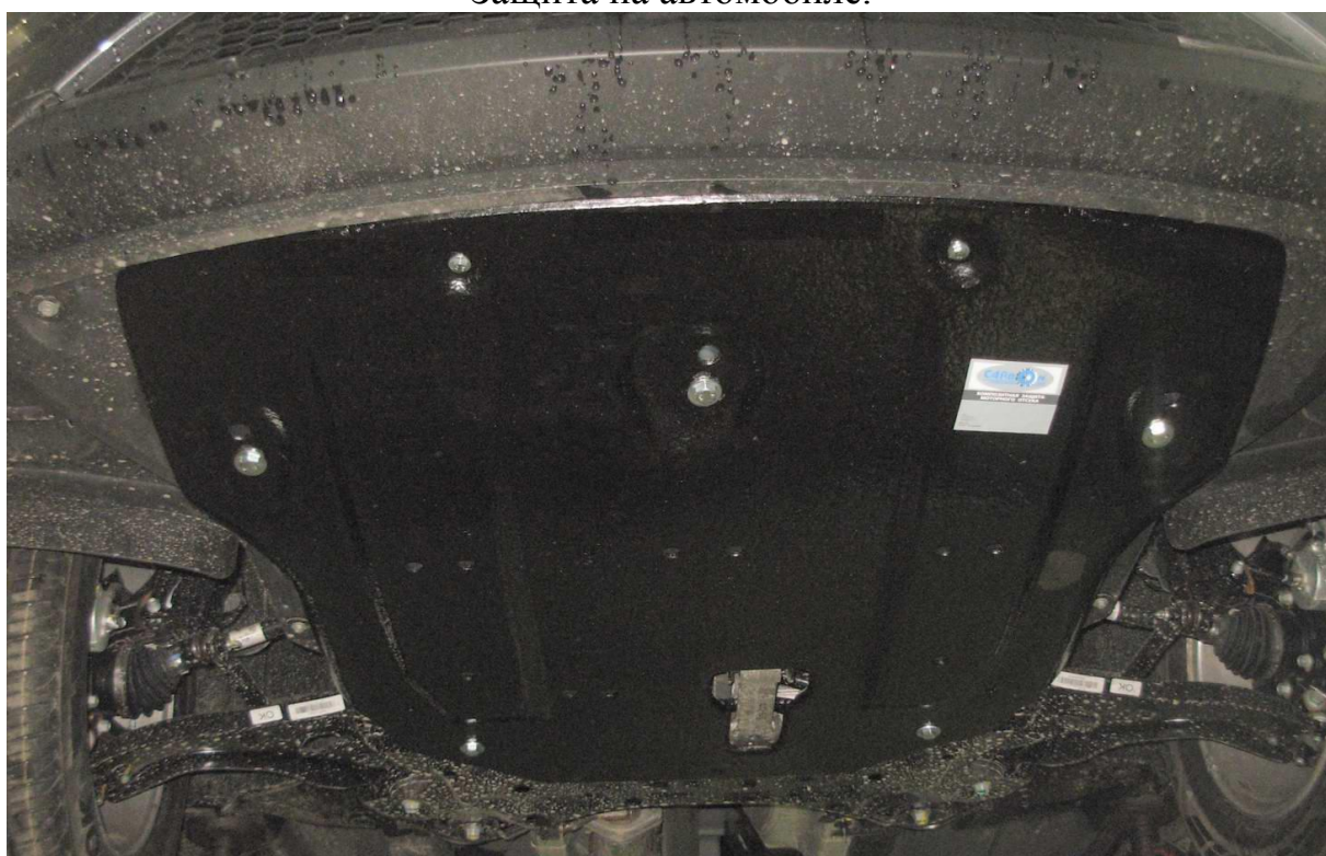
Места установки задних креплений. Защита на автомобиле.
