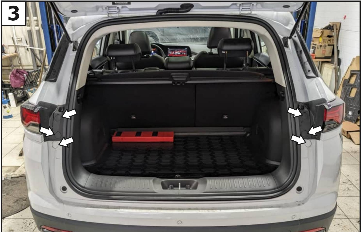
Снять заглушки крепления фонарей и бампера.
