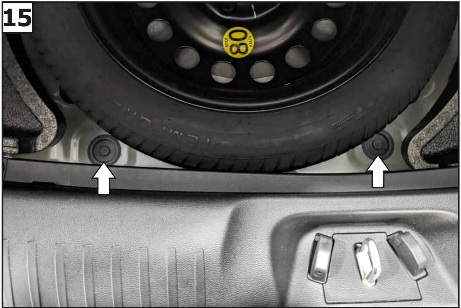
**В нише запасного колеса снять заглушки.**
