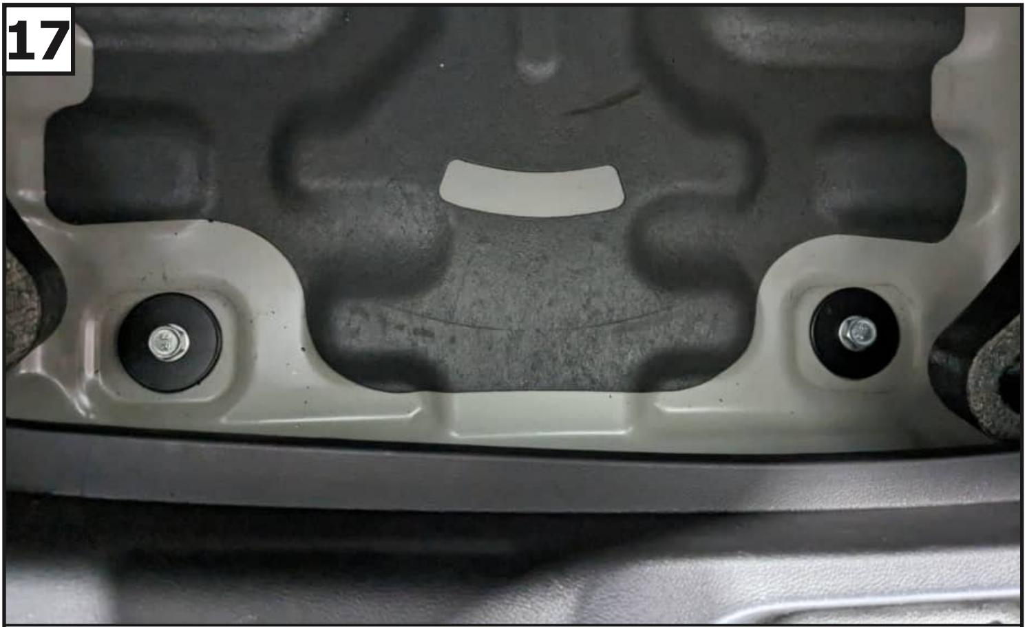
**Закрепить балку к нише запасного колеса с помощью проставок балки (6), шайб (8), болтов M12x1,25x50 (13), шайб 12 (19), шайб 12 пружинных (18) и гаек M12x1,25 (15).**
