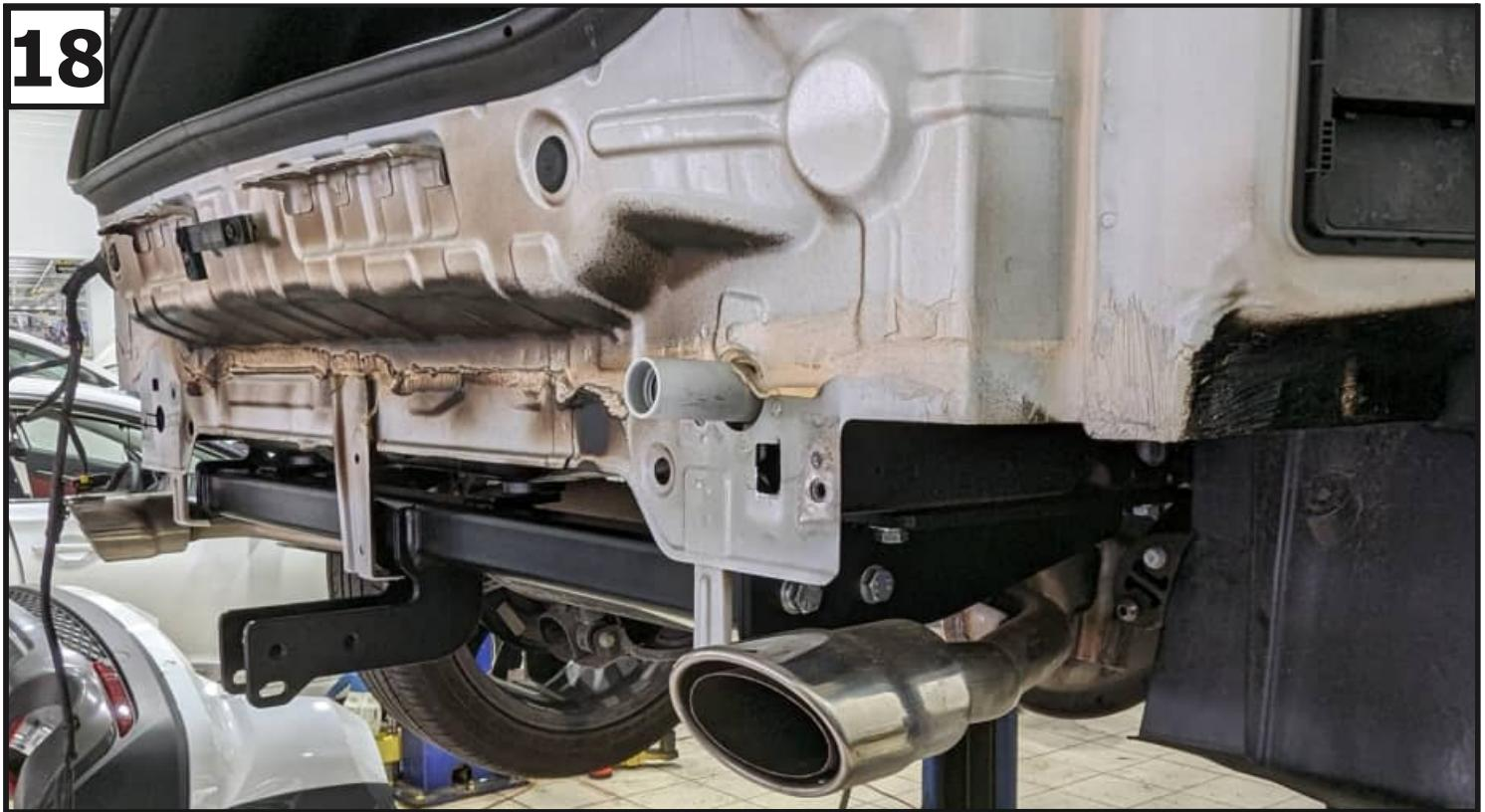
**Отрегулировать положение балки относительно центра автомобиля и затянуть все резьбовые соединения: сначала балку с кронштейнами, затем с нишей запасного колеса, после - кронштейны с лонжеронами. Моменты затяжки: M10=47 Нм; M12=81 Нм. Установить усилитель и бампер в обратном порядке.**
