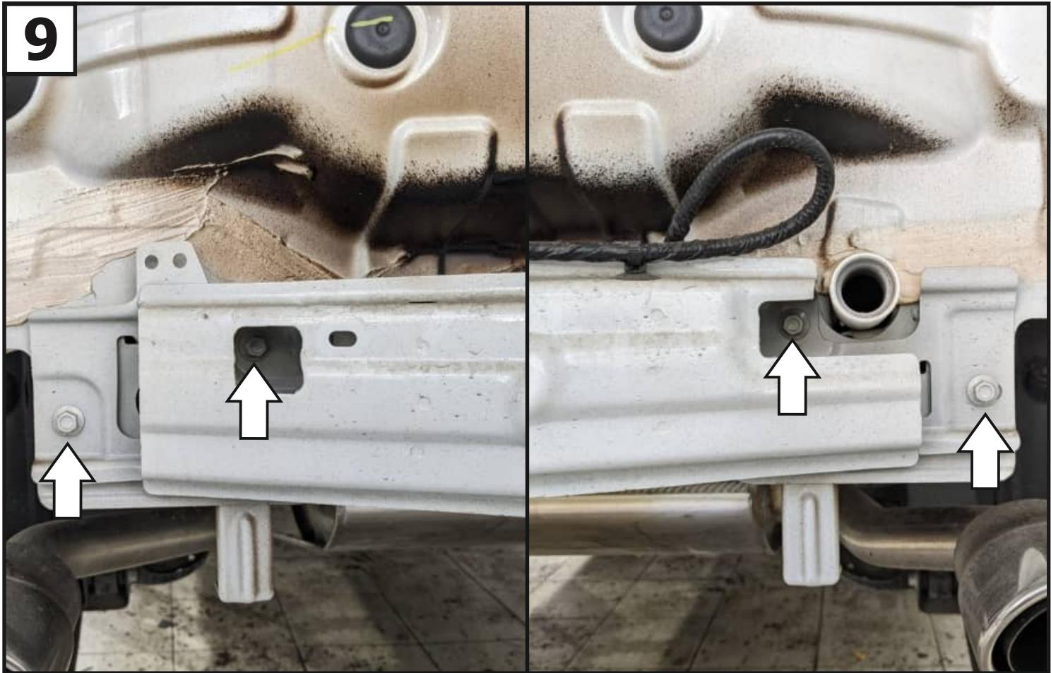
Открутить болты крепления усилителя бампера.
