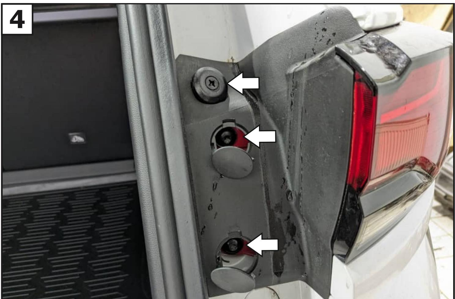
Открутить винты крепления фонарей. Демонтировать задние фонари.
