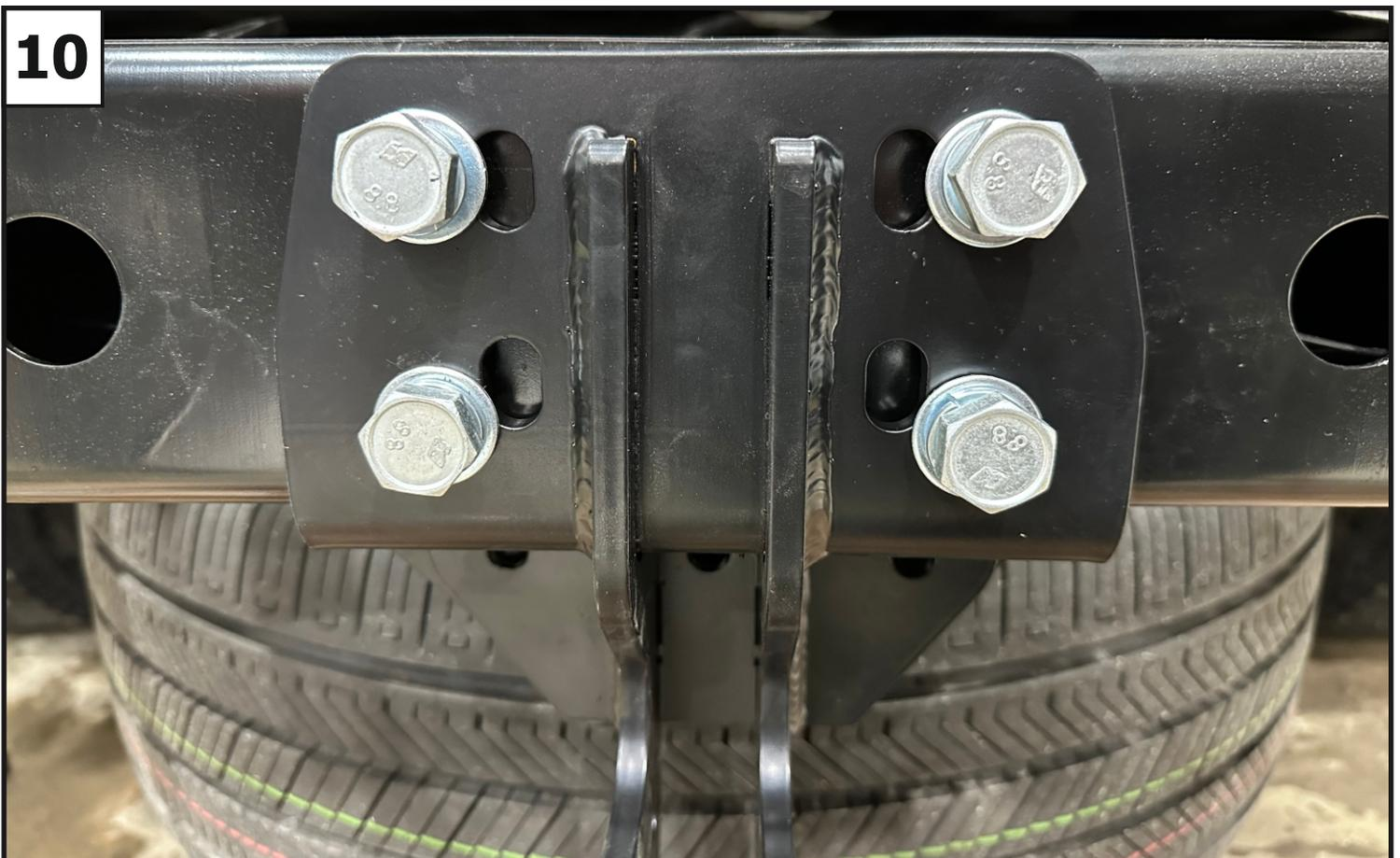
Установить кронштейн (1), закрепив его к поперечине с помощью болтов М14х1,5х40 (8), шайб М14 пружинных (12) и шайб М14 (13) (или использовать болты М12х1,25х40 (6), шайбы 12 пружинных (10) и шайбы 12 (11)).
