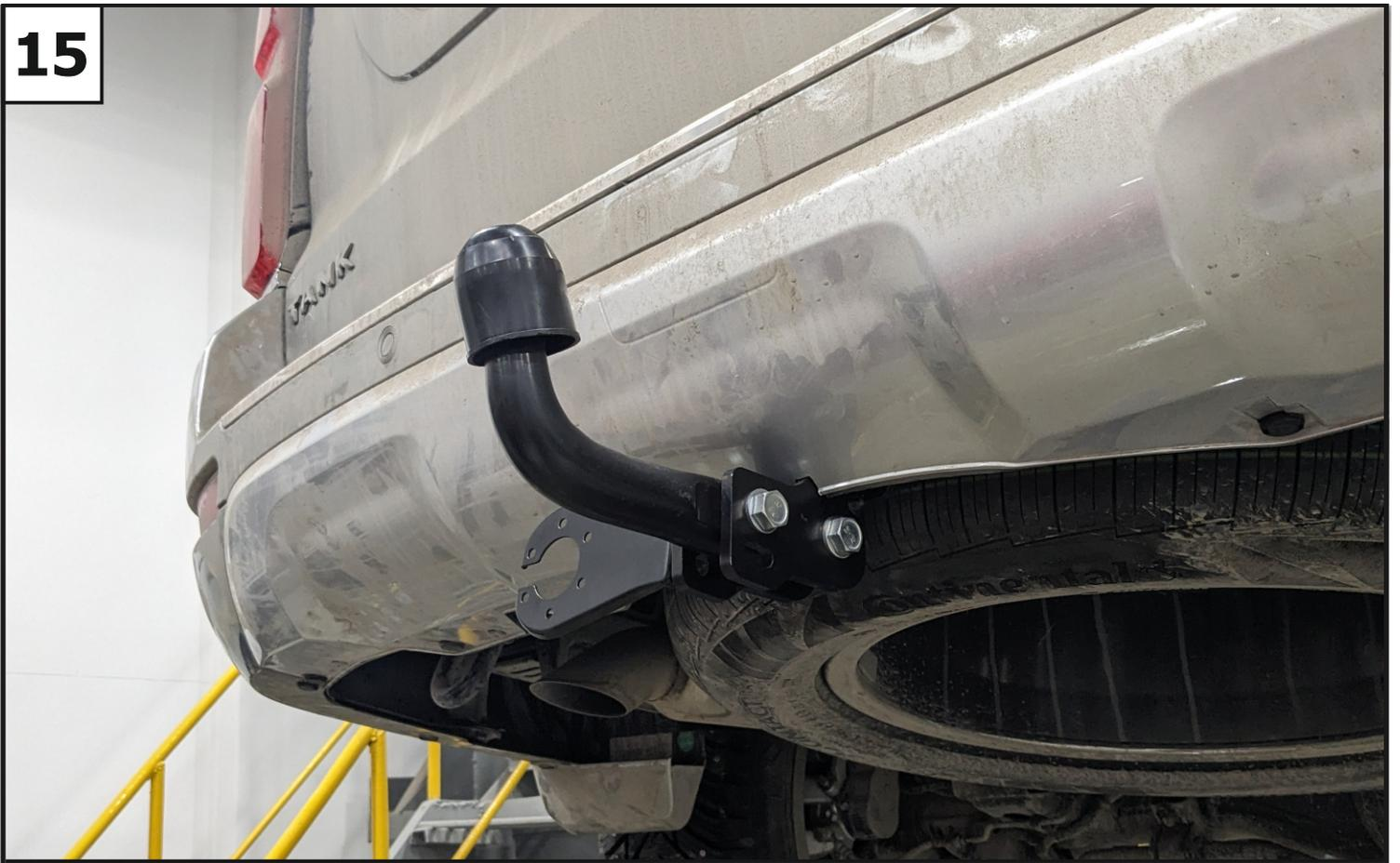
**Установить кронштейн под розетку (4) и крюк (5) с помощью болтов М12х1,25х70 (7), шайб 12 пружинных (10), шайб 12 (11) и гаек М12х1,25 (9). Затянуть все резьбовые соединения. Момент затяжки: М12=81 Нм.**
