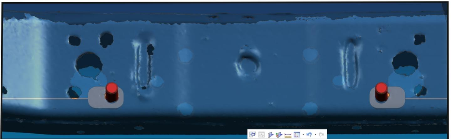
Установить закладные М12х1,25 (3) в поперечину рамы, обеспечив выход резьбы со стороны запасного колеса.
