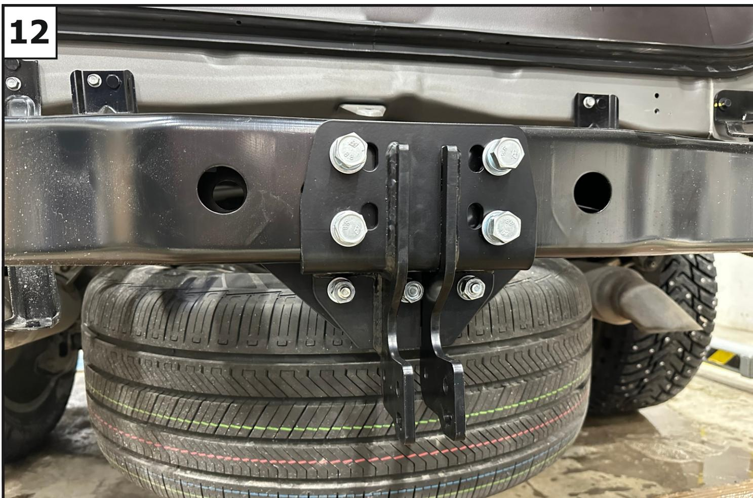
**Затянуть все резьбовые соединения. Моменты затяжки: М12=81 Нм, М14=126 Нм.**
