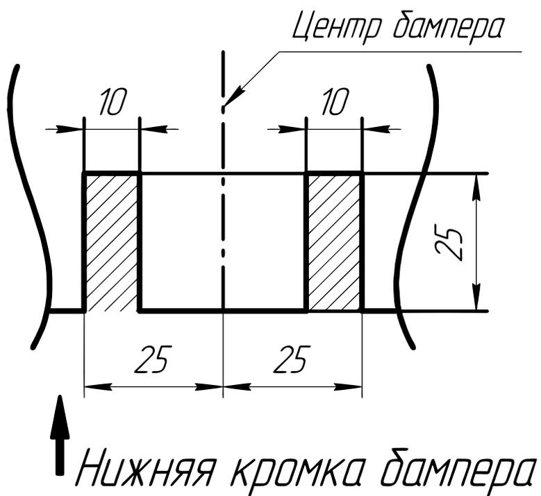
Выполнить подрезку бампера согласно схеме.
