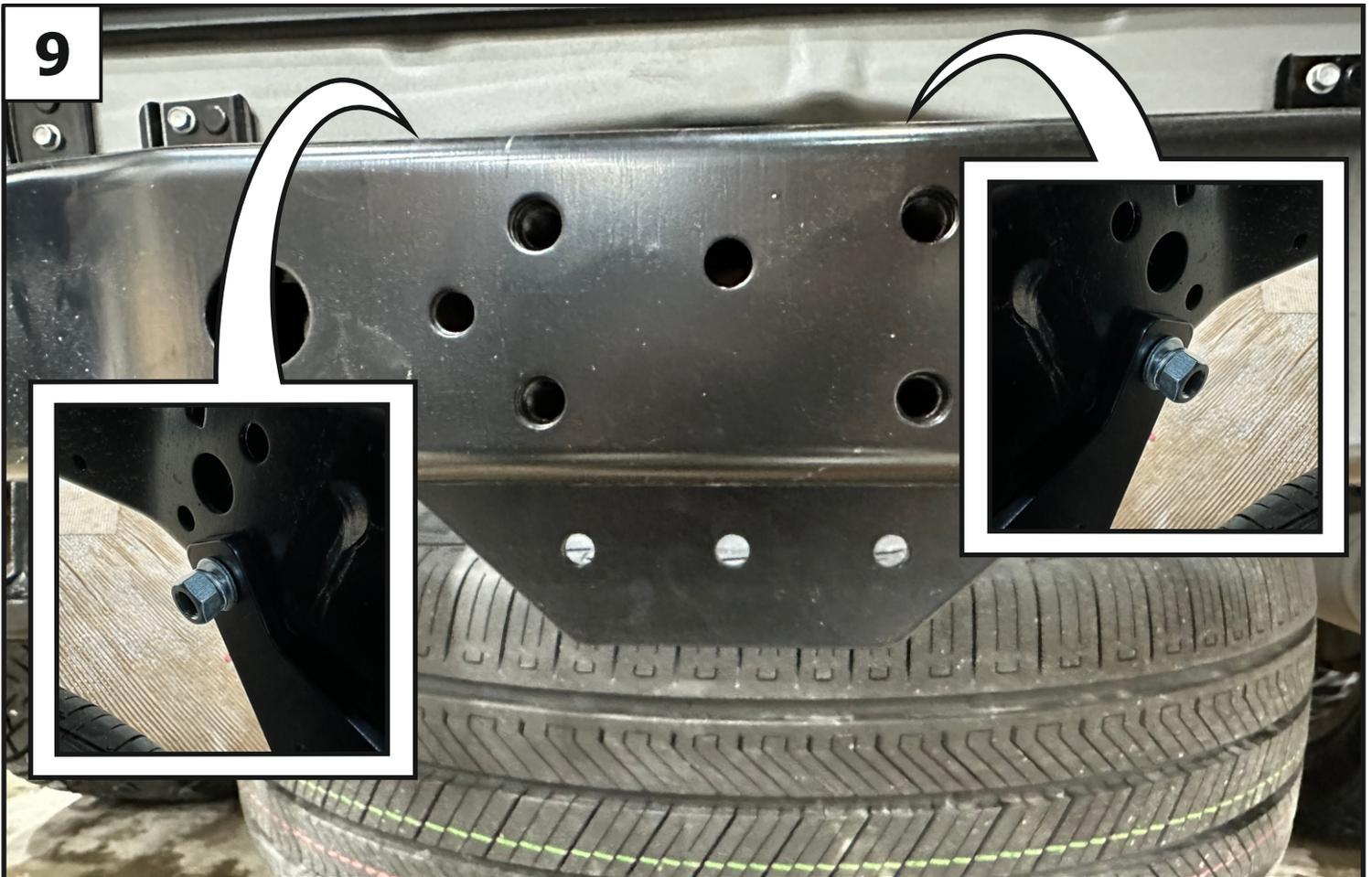
С обратной стороны поперечины установить усиливающую пластину (2), закрепив её к закладным с помощью гаек М12х1,25 (9), шайб 12 пружинных (10) и шайб 12 (11).
