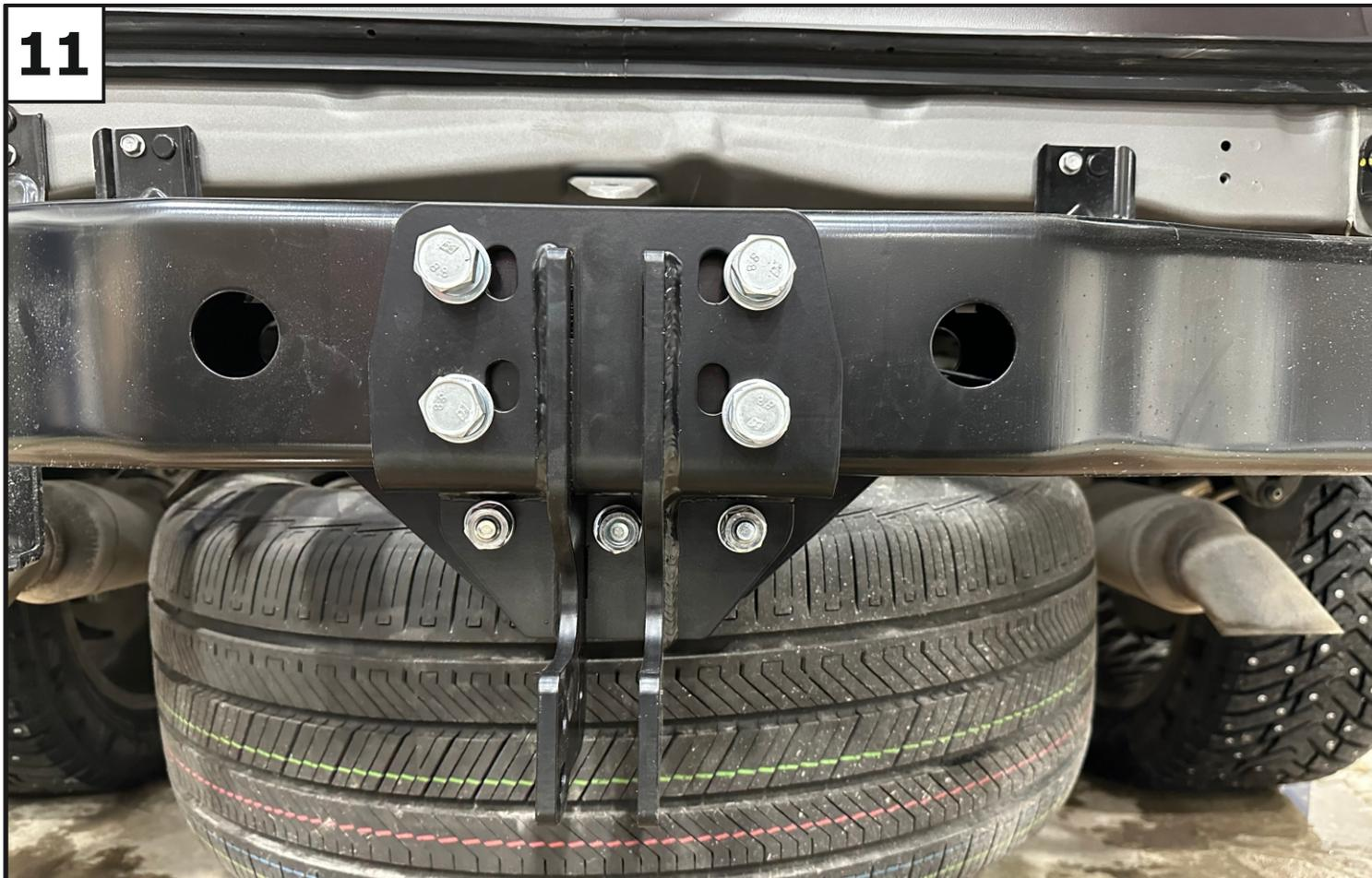
**Закрепить кронштейн (1) к усиливающей пластине (2) с помощью болтов М12х1,25х40 (6), шайб 12 пружинных (10), шайб 12 (11) и гаек М12х1,25 (9).**
