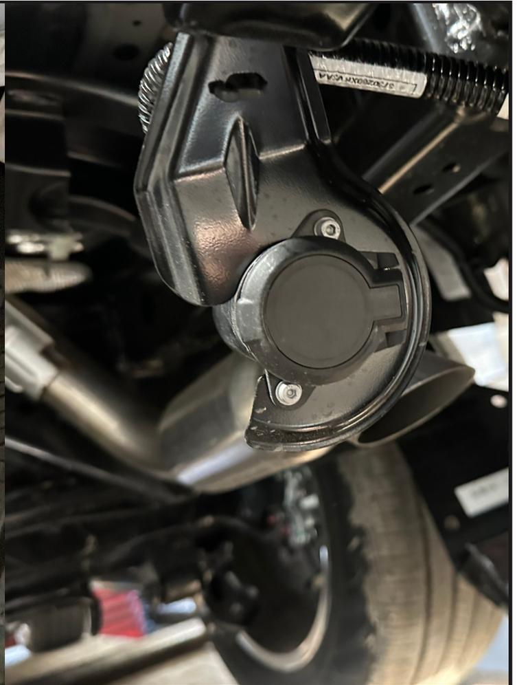
Отключить разъем электропроводки, демонтировать розетку и снять задний бампер.
