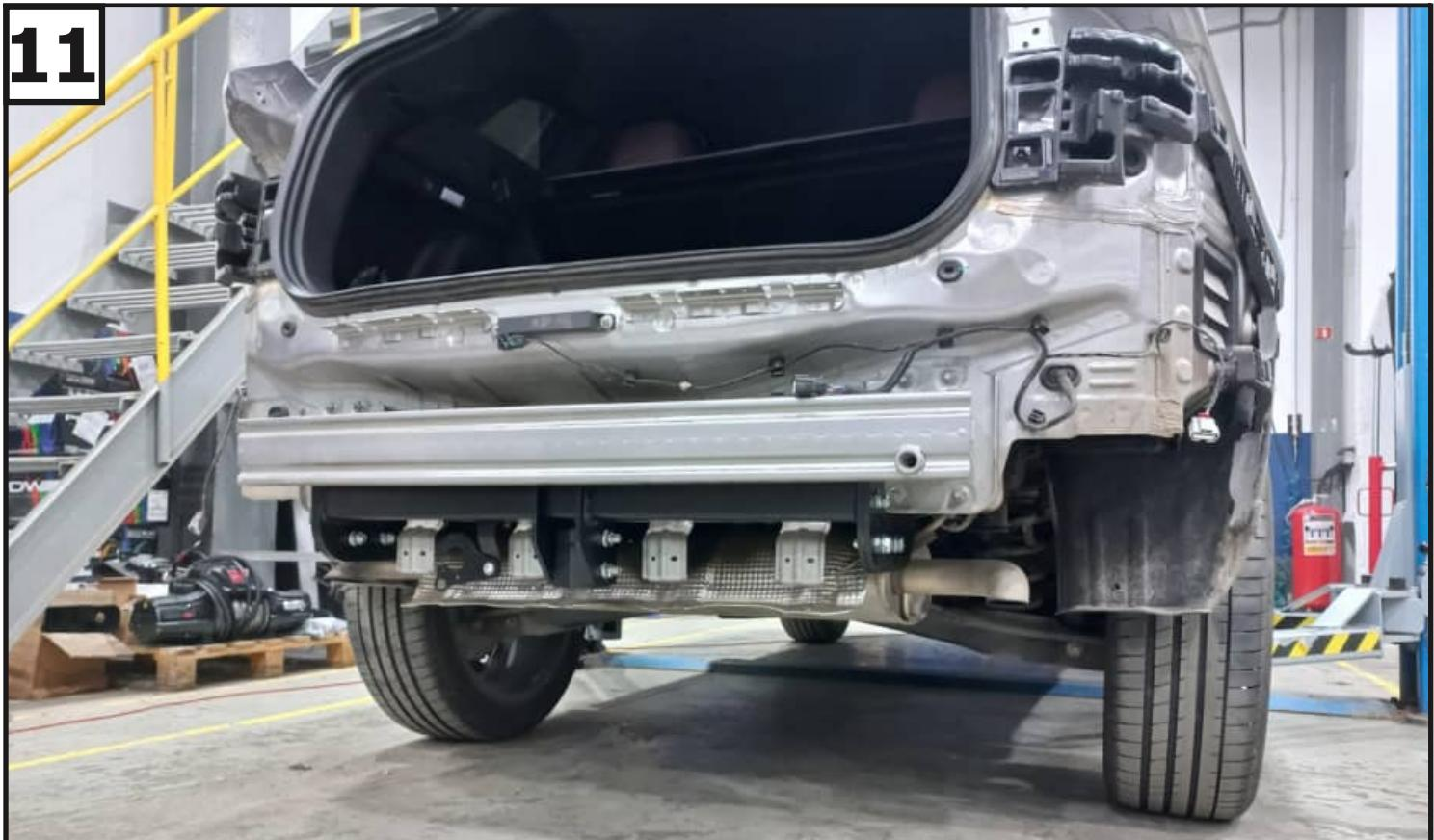
Затянуть все резьбовые соединения, сначала затянуть балку с кронштейнами, затем кронштейны к лонжеронам, после кронштейн под розетку к балке. Моменты затяжки: M6=6 Нм; M12=81 Нм.
