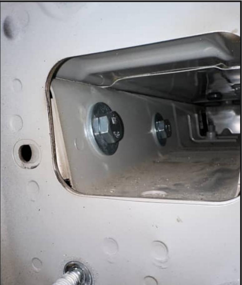
Установить правый кронштейн (3), закрепив его к правому лонжерону с помощью болтов M12x1,25x40 (8), гаек M12x1,25 (13), шайб 12 пружинных (17) и шайб 12 увел.(19). Левый кронштейн (2) установить аналогично.
