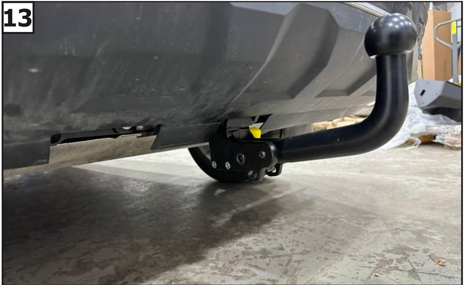
**Установить вставку быстросъема в ответную часть. Закрепить крюк с помощью винтов M12x45 (10).**
