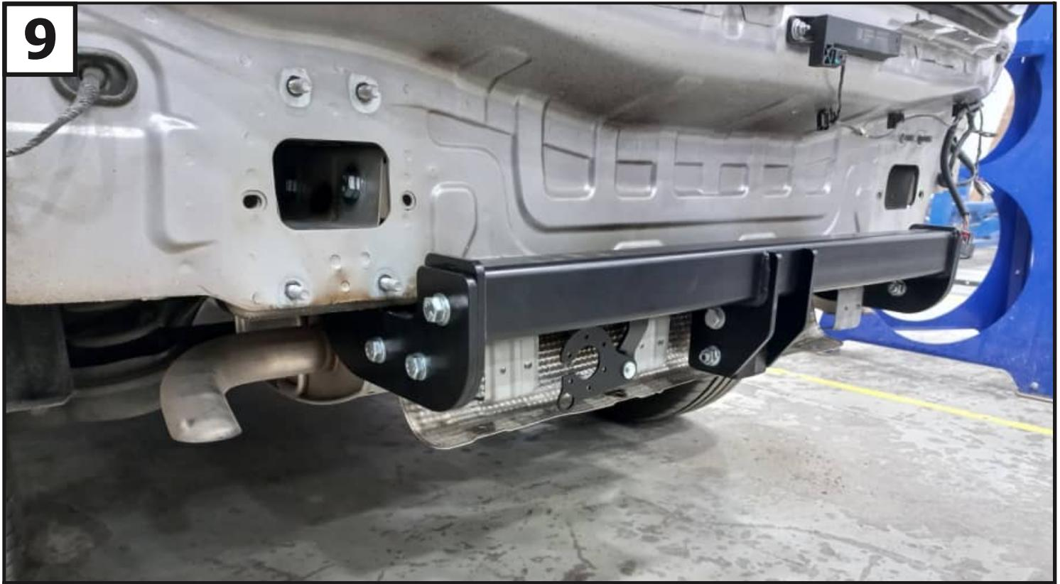
Установить балку (1), закрепив к кронштейнам болтами M12x1,25x40 (8), гайками M12x1,25 (13), шайбами 12 пружинными (17) и шайбами 12 (18). Установить кронштейн под розетку (4) с помощью болта M6x25 (7), гайки M6 (12), шайб 6 увеличенных (15) и шайб 6 полиамидных (16). Установить ответную часть быстросъема с помощью болта M12x1,25x100 (9), шайбы 12 с насечками (21), шпилек M12x25 (11) и M12x35 (20), гаек M12 с фланцем (14).
