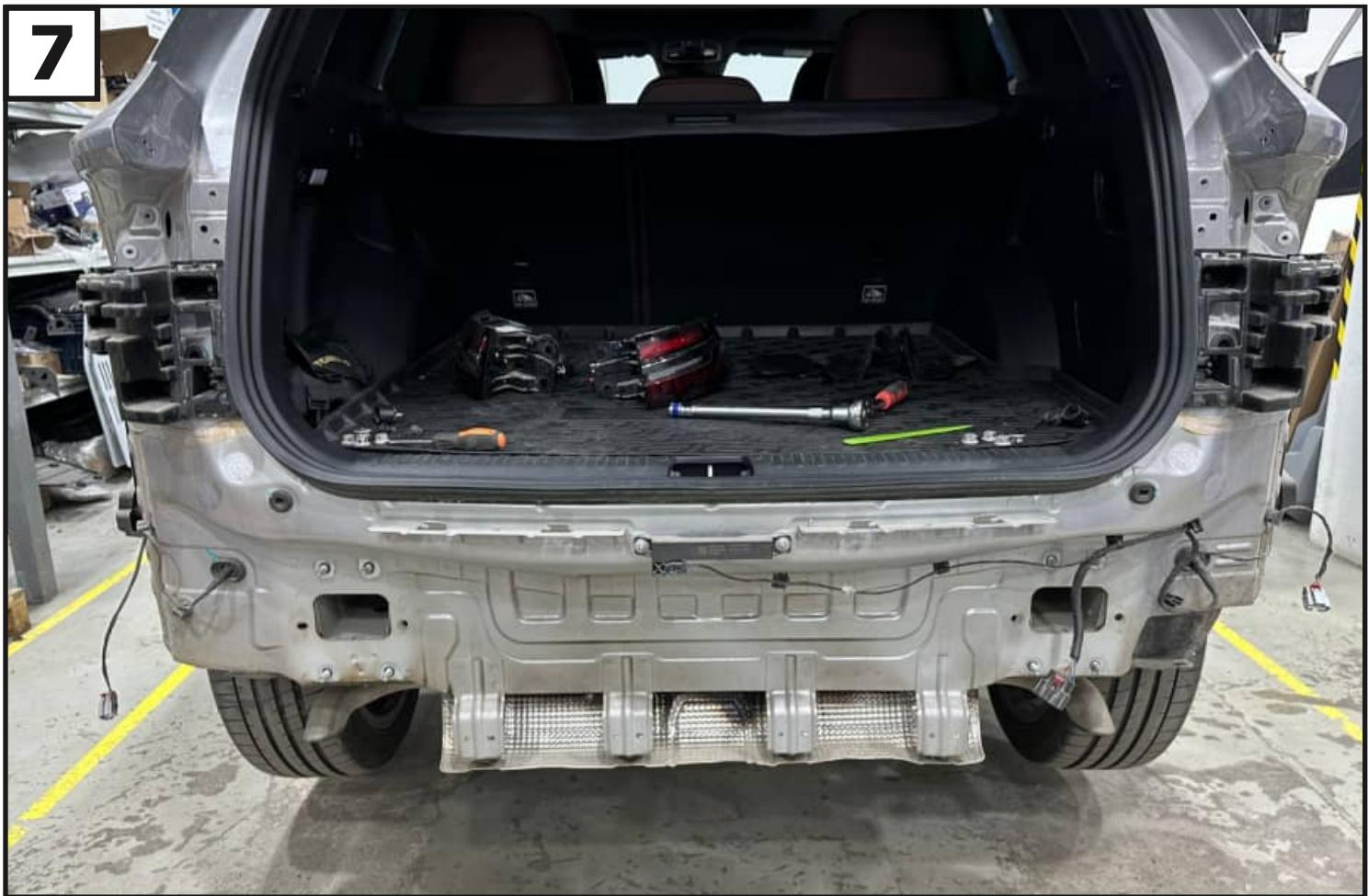
Снять усилитель бампера.
