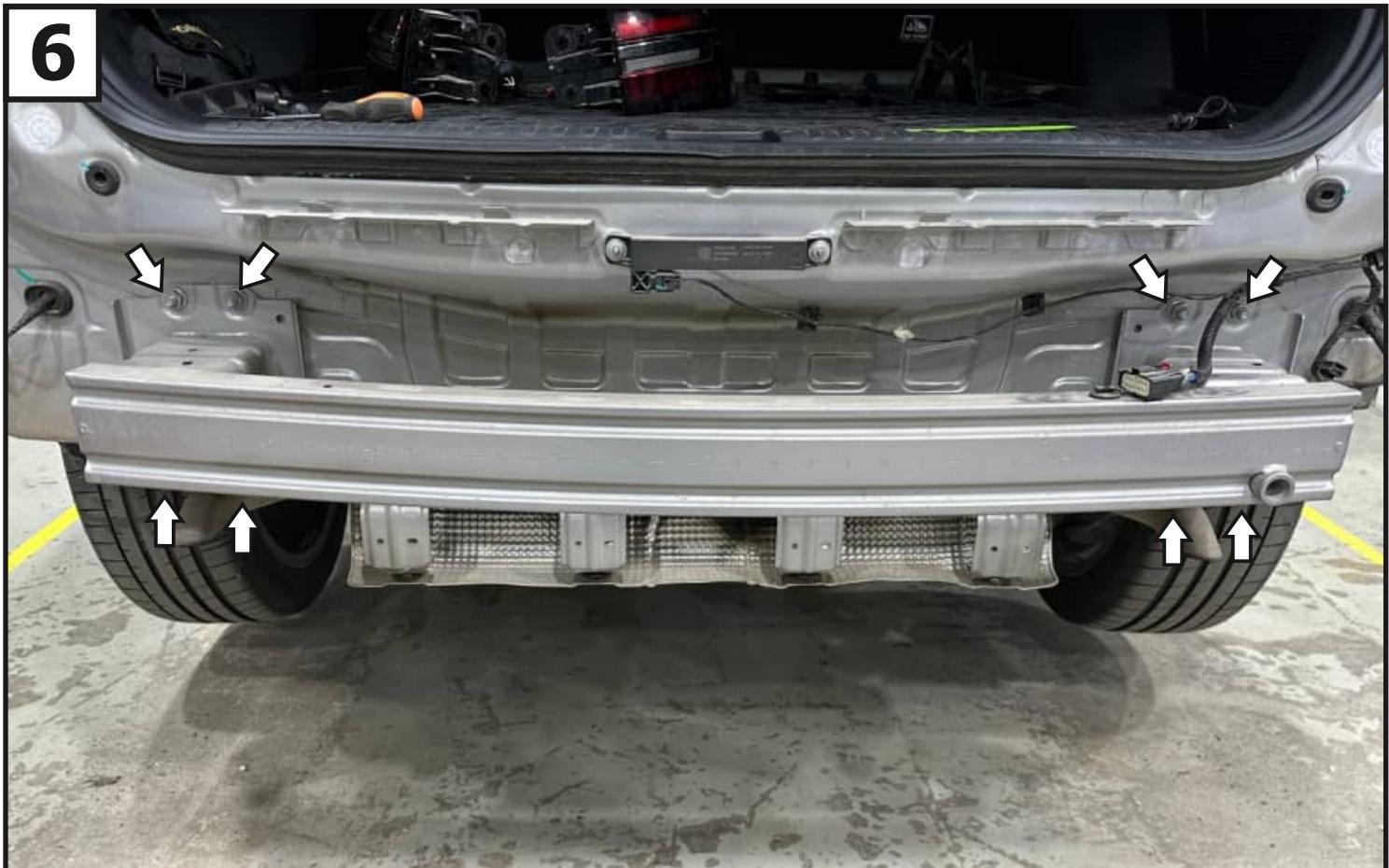
Открутить гайки крепления усиленителя заднего бампера.
