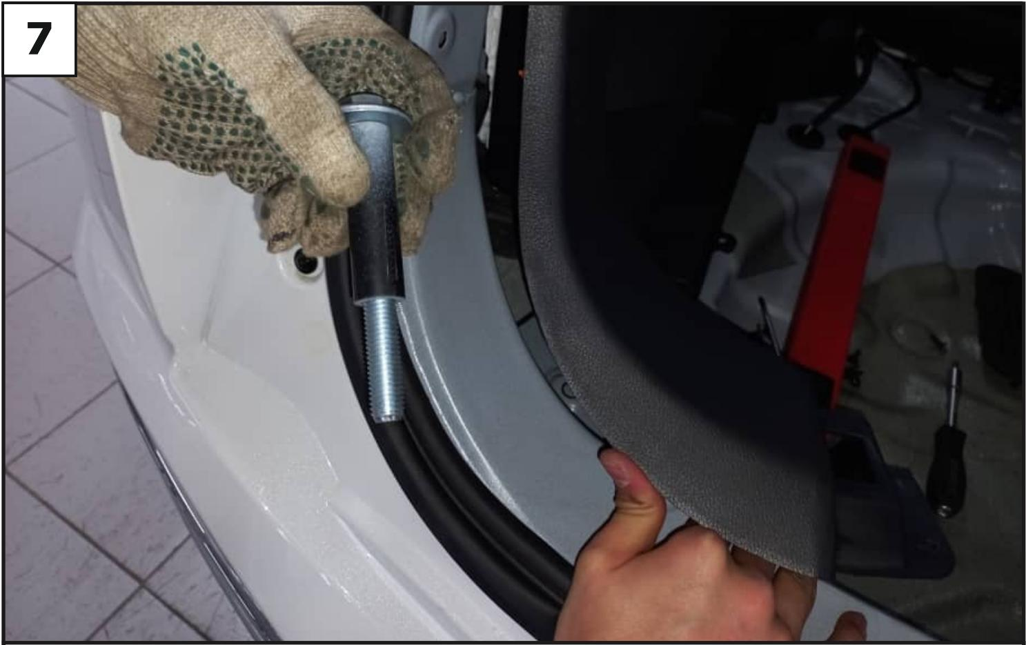
Установить в рассверленные отверстия болты M12x100 (9) с шайбами 12 увел. (13) и втулками (15).
