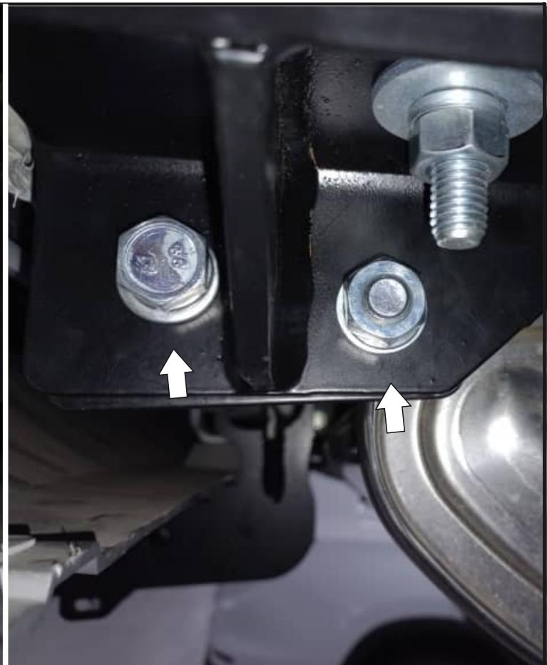
Затянуть все резьбовые соединения - сначала балку с кронштейнами, после кронштейны к лонжеронам. Моменты затяжки: M12= 81Нм.
