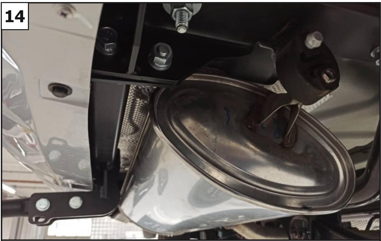
**К установленным кронштейнам закрепить балку (1) с помощью болтов M12x1,25x35 (7), шайб 12 (12), шайб 12 пружинных (14) и гаек M12x1,25 (10).**
