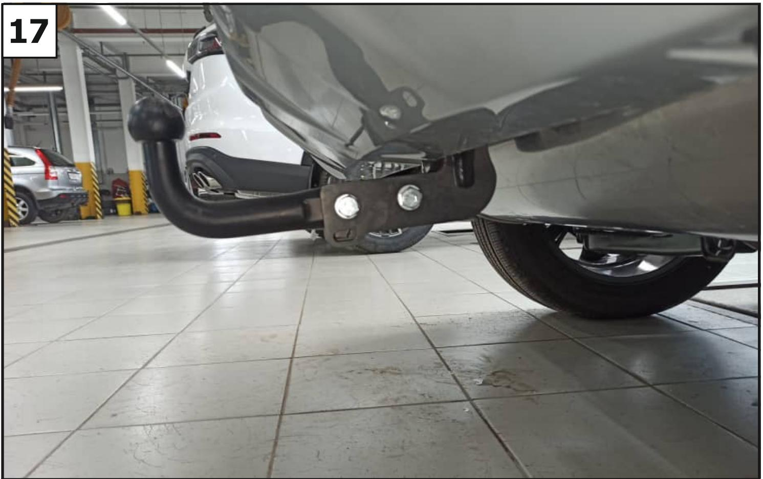
**Затянуть все резьбовые соединения. Моменты затяжки: M12=81Нм**
