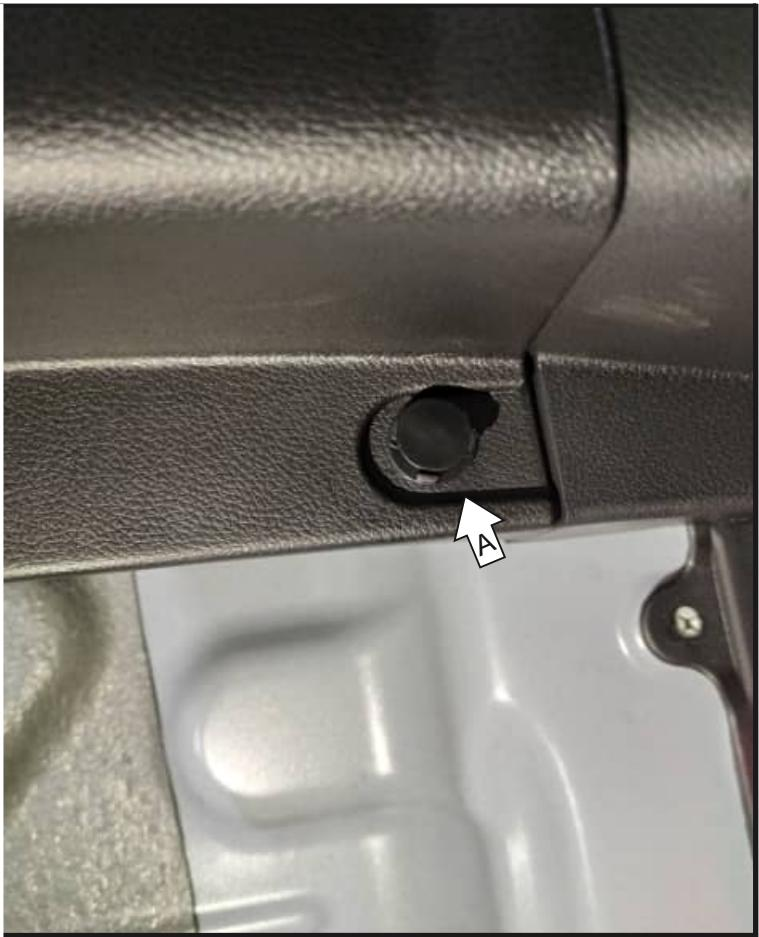
Демонтировать клипсы А обшивки багажника.
